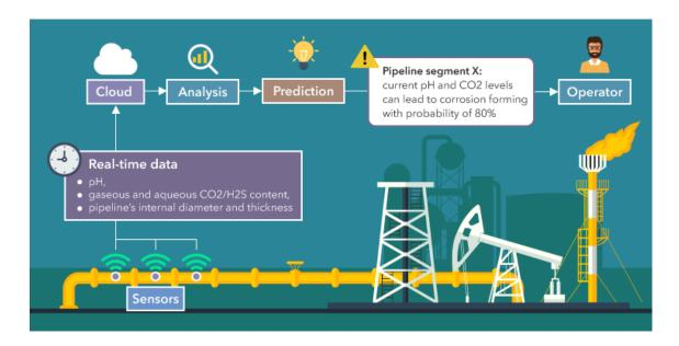
A manutenção preditiva (PdM) envolve a execução de verificações do sistema em intervalos predeterminados para analisar a integridade do equipamento. Esses controles são geralmente na forma de coleta contínua de dados (ou seja, temperatura, luz, pressão e som / vibração) do equipamento através do uso de sensores. Os resultados dessas verificações determinam se as atividades de manutenção são necessárias.
